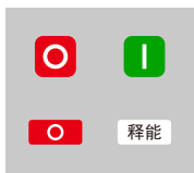
断路器断开且无储能状态
