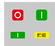
断路器合闸且已储能完毕状态
