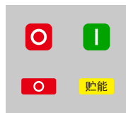
断路器断开且已储能完毕状态
